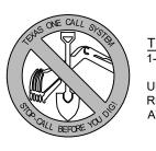
UNDER PENALTY OF LAW, THE CONTRACTOR IS REQUIRED TO CONTACT THE TEXAS ONE CALL SYSTEM AT LEAST 48 HOURS BEFORE STARTING EXCAVATION.
